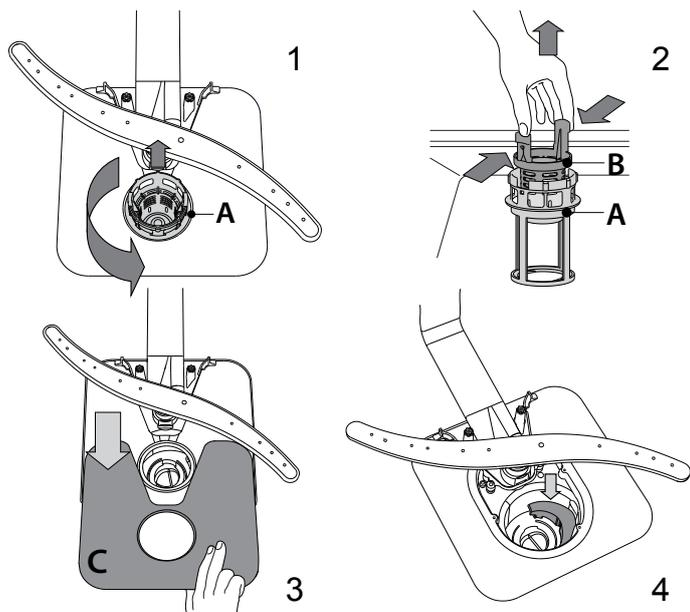
Ko ste očistili filtre, filtrirni sklop znova sestavite in ga pritrdite v pravi položaj. Ta postopek je ključnega pomena pri vzdrževanju brezhibnega delovanja pomivalnega stroja.
