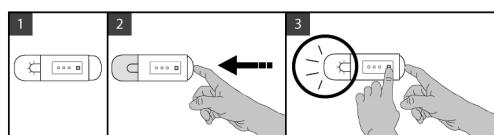
Ventilatoren er forudindstillet til ON. For at slukke for ventilatoren gøres følgende: Tryk på pærens knap som vist på figur 2.
