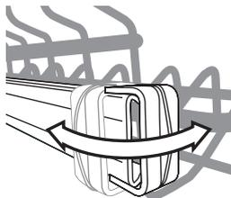
Откройте два блокировочных рычага справа и слева и выньте корзину. С установленной верхней корзиной блокировочные рычаги должны быть всегда закрыты.
