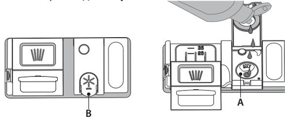
1. Откройте дозатор **B**, нажав и потянув вверх язычок крышки.
