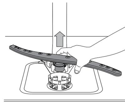
Нижнюю лопасть можно снять, потянув ее вверх.
