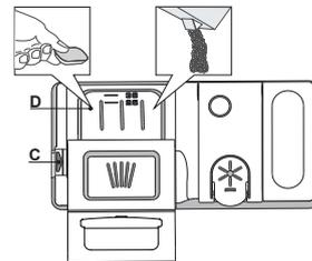
1. Для определения требуемого количества моющего средства см. указания выше. С внутренней стороны лотка **D** нанесены мерные отметки, позволяющие правильно дозировать моющее средство.
