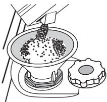
1. Выньте нижнюю корзину и отвинтите крышку бачка (против часовой стрелки).
