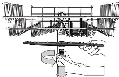
Для снятия верхней лопасти поверните пластмассовое удерживающее кольцо против часовой стрелки. Устанавливайте верхнюю лопасть так, чтобы сторона с большим количеством отверстий была обращена вверх.
