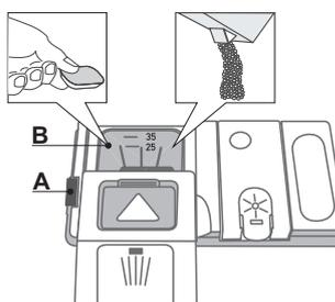
**Para abrir o distribuidor de detergente utilize o dispositivo de abertura A.**
