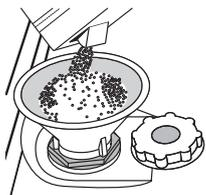
1. Retire a prateleira inferior e desaperte a tampa do depósito (para a esquerda).
