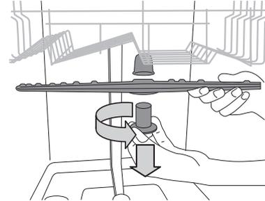
Para retirar o braço aspersor superior, rode o anel de retenção de plástico para a esquerda. O braço aspersor superior deve ser substituído para que o lado com o mais número de orifícios fique virado para cima.
