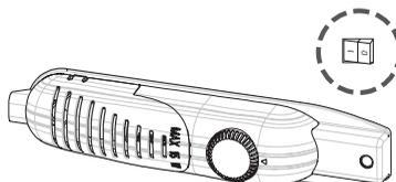
**Als het apparaat wordt uitgeschakeld of de stekker wordt uitgetrokken, moet u tenminste 5 minuten wachten alvorens het apparaat terug in te schakelen of de stekker in het stopcontact te steken om de compressor niet te beschadigen.**
