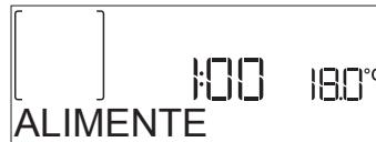
Se va emite un semnal sonor, iar pe afișaj va fi indicată acțiunea care trebuie desfășurată. Deschideți ușa, executați acțiunea indicată pe afișaj și închideți ușa, apoi apăsați pentru a continua procesul de preparare.
