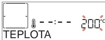
Jakmile požadované hodnoty blikají na displeji, stiskněte + nebo — pro provedení změny a poté, pro potvrzení volby, stiskněte ✓ a pokračujte v provádění následujícího nastavení (je-li to možné).
