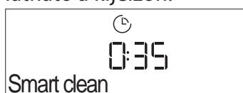
A funkció bekapcsolásához nyomja meg a  gombot: a kijelzőn látható figyelmezhetők jelzik, milyen műveletek szükségesek a legjobb tisztítási eredményhez: Kövesse az utasításokat. Ha kész, nyomja meg a  gombot. Ha az összes lépést végrehajtotta, a megfelelő időben nyomja meg a  gombot a tisztítási program bekapcsolásához.
