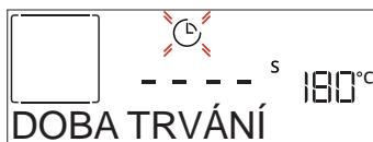
Jakmile ikona ☰ bliká na displeji, stiskněte + nebo — pro nastavení požadované doby přípravy a poté, pro potvrzení, stiskněte ✓. Dobu pečení nemusíte nastavovat, pokud si přejete pečení řídit ručně (bez použití časovače): Stiskněte ✓ nebo ☰ pro potvrzení a aktivujte funkci. V tomto režimu nelze naprogramovat odložený start.
