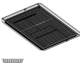
Izmantojet pārtikas produktu gatavošanai ar cepšanas ar gaisu funkciju, novietojot cepšanas paplāti zemākā līmenī, lai tajā tiktu savāktas iespējamās drupačas un noplējušais šķidrums.
