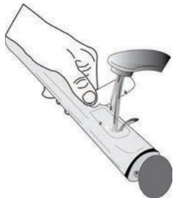
Selezionare la funzione "Drain" (Scarico) con il cassetto dell'acqua correttamente inserito nel forno, premere e attendere che il ciclo venga eseguito automaticamente. La durata media dello scarico acqua a pieno carico è di circa un minuto. Una volta fatto, il
