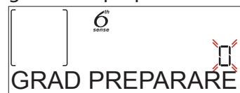
Atunci când vi se solicită acest lucru, apăsați pe + sau — pentru a selecta nivelul dorit, de la preparate în sânge (-1) la preparate bine făcute (+1). Apăsați ✓ sau pentru a confirma și porniți funcția.
