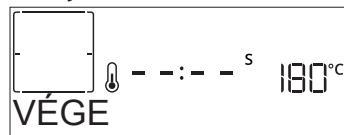
A sütés manuális (időzítés nélküli) üzemmódban történő folytatásához nyomja meg a □ gombot. Ha növelni kívánja a sütési időt, nyomja meg a +
