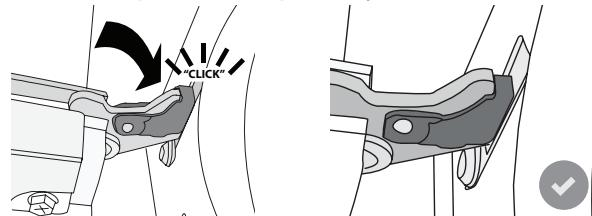
5. Poskusite zapreti vrata in preverite, da so poravnana z upravljalno ploščo. Če vrata niso poravnana, ponovite zgoraj opisane korake: če se vrata ne odpirajo in zapirajo pravilno, se lahko poškodujejo.
