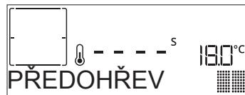
Po ukončení této fáze zazní zvukový signál a displej bude indikovat dosažení nastavené teploty a zobrazovat pokyn „VLOŽTE JÍDLO“. V tomto okamžiku otevřete dvířka, vložte jídlo do trouby, zavřete dvířka a stiskem **✓** nebo **►** zahajte pečení.
