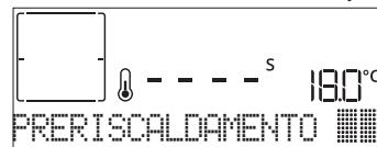
Al termine di questa fase, un segnale acustico e il display indicheranno che il forno ha raggiunto la temperatura impostata e comparirà la richiesta "AGG. ALIMENTO". A questo punto aprire la porta, infornare gli alimenti, chiudere la porta e avviare la cottura premendo **✓** o **►**.
