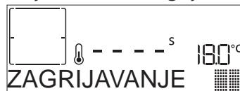
Po završetku te faze oglasit će se zvučni signal i na zaslonu će se prikazati da je pećnica dosegla postavljenu temperaturu tražeći da se „DODAJ NAMIRNICE“. Tada otvorite vrata, stavite namirnice u pećnicu, zatvorite vrata i započnите kuhanje pritiskom na **✓** ili **►**.
