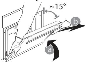
3. Ukse tagasipaigaldamiseks asetage see vastu ahju, joondage hingede haagid pesadega ja kinnitage ülemine osa oma pessa.
