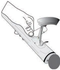
Selectați funcția „Evacuare” cu sertarul pentru apă introdus corespunzător în cuptor, apăsați pe și așteptați ca ciclul să ruleze automat. Durata medie pentru evacuarea completă este de aproximativ un minut. După aceea, sertarul poate fi scos și golit.
