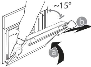
3. Dvířka opět nasadíte tak, že je přiložíte k troubě, nasmerujete háčky pantů oproti jejich usazení a do příslušného usazení zajistíte i horní část.
