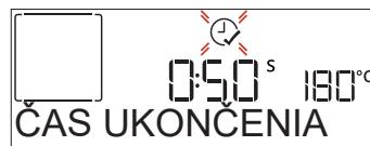
Želaný čas ukončenia prípravy jedla nastavíte stlačením + alebo — , potvrdte ho stlačením ✓ a aktivujte funkciu. Vložte jedlo do rúry a zatvorte dvierka: Funkcia sa spustí automaticky po uplynutí času vypočítaného tak, aby sa príprava jedla ukončila v čase, ktorý ste nastavili.
