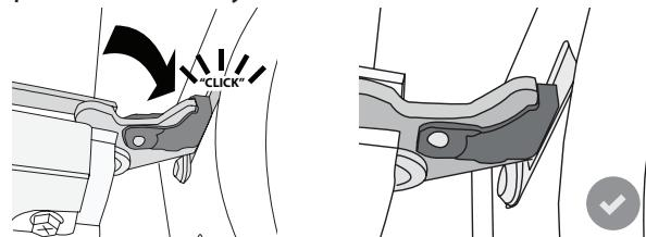
5. Yritä sulkea luukku, jotta voit tarkistaa, että se on kohdistettu käytöpaneeliin. Jos näin ei ole, toista yllä olevat vaiheet: Jos luukku ei toimi oikein, se saattaa vahingoittua.
