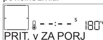
Ko se na zaslonu prikaže ustrezno sporočilo, če je zahtevano, pritisnite za zagon petminutnega cikla za porjavenje. Funkcijo lahko kadar koli prekinete s pritiskom na za izklop pečice.
