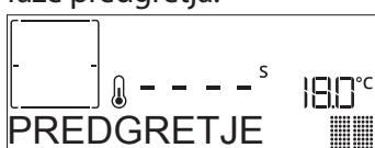
Po koncu te faze se oglaši zvočni signal, na zaslonu pa se prikaže sporočilo, da je pečica dosegla nastavljeno temperaturo, ki vas pozove „ADD FOOD“ (DODAJ ŽIVILO). Takrat odprite vrata, položite živilo v pečico, zaprite vrata in začnite pripravo s pritiskom na ali .
