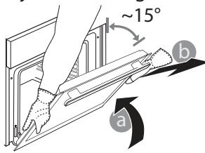
3. Sätt tillbaka luckan genom att flytta den mot ugnen och placera gångjärnens krokar i höjd med fästet och fästa den övre delen på fästet.
