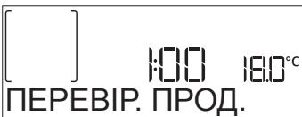
Пролунає звуковий сигнал і на дисплей буде відображене дію, яку потрібно виконати. Перевірте страву, закрийте дверцята і натисніть **▷** або **✓**, щоб продовжити готовування.
