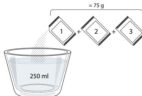
Pēc atkaļkošanas šķiduma iepildes atvilktnē nospiediet lai sāktu galveno atkaļkošanas procesu. Kalķakmens tīrišanas posmu laikā jums nav jāatrodas pie ierīces. Pēc katra posma pabeigšanas tiks atskanots akustisks signāls, un displejā tiks parādīti norādījumi, kā turpināt nākamo posmu.
