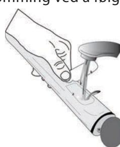
Velg funksjonen "Drenering" når vannskuffen er riktig innsatt i ovnen, trykk på  og vent til syklusen kjøres automatisk. Tømmingen av full beholder varer i gjennomsnitt i ett minutt. Når det er gjort, kan skuffen trekkes ut og tömmes.
