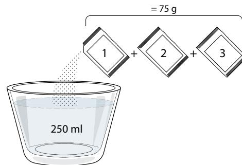
Kui olete katlakivieemaldi lahuse sahlisse valanud, vajutage nuppu , et käivitada katlakivi eemaldamise põhiprotsess. Katlakivi eemaldamise etapid ei nõua seadme ees viibimist. Pärast iga faasi lõppu esitatakse akustiline tagasiside ja ekraanil kuvatakse juhised järgmise etapi jätkamiseks. Pärast katlakivi eemaldamist lastakse katel tühjaks: selles etapis kasutatav katlakivieemalduslahus valatakse väljavõetavasse sahlisse.
