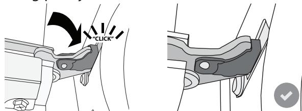
5. Prøv å lukke døren og sjekk for å være sikker på at den er på linje med kontrollpanelet. Dersom den ikke gjør det, må trinnene ovenfor gjentas: Døren kan skades dersom den ikke lukker seg på riktig måte.
