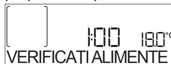
Se va emite un semnal sonor, iar pe afișaj va fi indicată acțiunea care trebuie desfășurată. Verificați alimentele, închideți ușa și apăsați pe sau pentru a continua prepararea.
