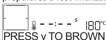
Atunci când pe afișaj apare mesajul aferent, dacă este necesar, apăsați pe pentru a porni un ciclu de rumenire de cinci minute. Puteți opri funcția oricând apăsând pentru a opri cuptorul.
