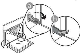
2. Zatvorite vrata koliko god to možete. Čvrsto uhvatite vrata s obje ruke; ne držite ih za ručku. Vrata jednostavno skinite tako da ih nastavljate zatvarati dok ih istovremeno vučete prema gore dok se ne otpuste iz ležišta. Stavite vrata sa strane, oslanjajući ih na meku površinu.
