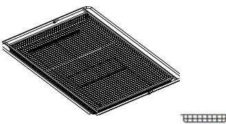
Používá se při přípravě pokrmů s funkcí Air Fry, kdy je pečící plech umístěn na nižší úrovni, aby se zachytily případné drobky a kapky.
