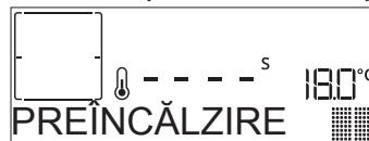
Odată ce această etapă este finalizată, se va emite un semnal sonor, iar afișajul va indica faptul că cuptorul a atins temperatura setată, fiind necesar să „ADAUGĂ ALIMENTE”. În acest moment, deschideți ușa, așezați alimentele în cuptor, închideți ușa și începeți prepararea prin apăsare pe sau .
