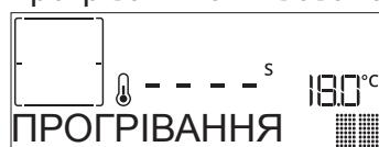
Після завершення цієї фази пролунає сигнал і на дисплеї з'явиться повідомлення про те, що духовна шафа досягла встановленої температури та необхідно «ДОДАТИ ПРОДУКТИ». В цей момент відкрийте дверцята, покладіть продукти до духової шафи, закройте дверцята і запустіть готовування, натиснувши або .
