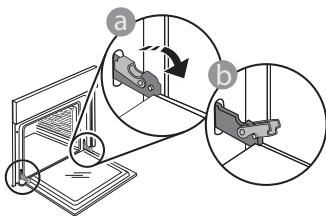
2. Uždarykite dureles. Dureles laikykite tvirtai abiem rankom – nelaikykite suėmę už rankenos.
