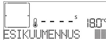
Kun tämä vaihe on päättynyt, kuuluu äänimerkki ja näyttö osoittaa, että uuni on saavuttanut asetetun lämpötilan; "LISÄÄ RUOKA". Avaa nyt luukku, aseta ruoka uuniin, sulje luukku ja aloita kypsennys painamalla ✓ tai ▶.
