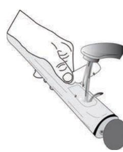
Valitse "Tyhjennys"-toiminto vesilaatikon ollessa asianmukaisesti asetettuna uuniin, paina ☰ ja odota kunnes jakso on suoritettu automaatisesti. Täydellä kuormituksella suoritettavan tyhjennyksen keskimääräinen kesto on noin yksi minuutti. Kun tämä on tehty, laatikko voidaan poistaa ja tyhjentää.
