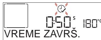
Pritisnite + ili — da podesite željeno vreme završetka kuvanja, zatim pritisnite ✓ za potvrdu i aktiviranje funkcije. Stavite hranu u pećnicu i zatvorite vrata: Funkcija se pokreće automatski nakon vremenskog perioda koji je izračunat kako bi se kuvanje završilo u vreme koje ste vi podesili.
