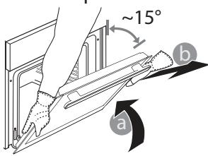
3. Įstatydamis dureles pastumkite jas link orkaitės, sulygiuokite vyrių kabliukus tvirtinimo vietose ir užfiksuodami viršutinę dalį.
