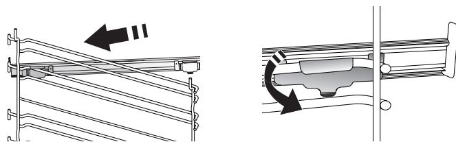
Upozornění: Posuvné drážky lze nainstalovat do kterékoli úrovně.
