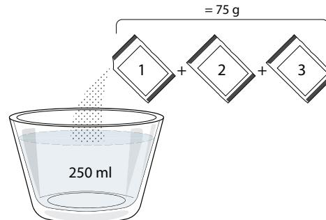
Una volta versata la soluzione decalcificante all'interno del cassetto, premere per avviare il processo di decalcificazione principale. Le fasi di decalcificazione non richiedono la presenza dell'utente davanti all'apparecchio. Al termine di ogni fase, verrà riprodotto un feedback acustico e il display mostrerà le istruzioni per procedere con la fase successiva.
