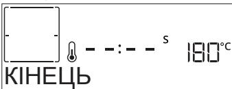
Натисніть **▷**, щоб продовжувати готовування в ручному режимі (без таймера) або натисніть **+**, щоб збільшити час готовування, встановивши нову тривалість. В обох випадках параметри приготування будуть збережені.
