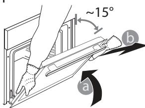
3. Asenna luukku takaisin siirtämällä se uunin lähelle, kohdistaan saranoiden koukut sijoituskohtiin ja kiinnittämällä yläosan paikalleen.
