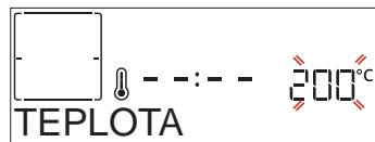
Ked' na displeji bliká hodnota, pomocou + alebo — ju zmeňte, potom potvrdte stlačením ✓ a pokračujte zmenou nasledujúcich nastavení (ak je to možné).
