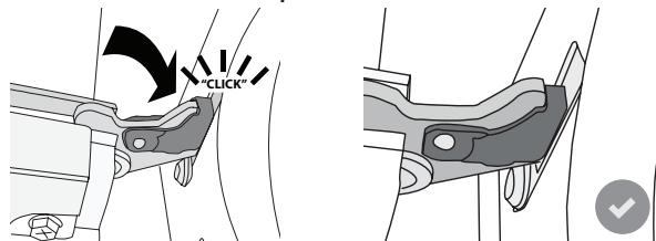
5. Provare a chiudere la porta, verificando che sia allineata al pannello di controllo. Nel caso non lo fosse, ripetere i passi sopra descritti: La porta potrebbe danneggiarsi se non funziona correttamente.
