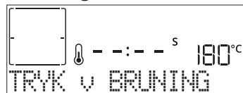
Når displayet viser den relevante meddeelse, kan man, om nødvendigt, trykke på **✓**, for at starte en bruningscyklus på fem minutter. Du kan stoppe funktionen når som helst ved at trykke på knappen **⊕**, for at slukke ovnen.
