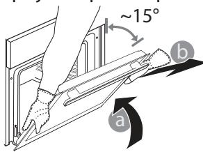
3. Remontați ușa deplasând-o spre cuptor, aliniind cuplajele balamalelor cu locașurile și fixând partea superioară în locaș.
