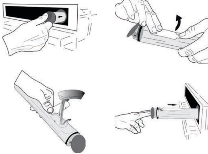
Dopo il primo riempimento, in caso di cicli di cottura più lunghi, una volta esaurita l'acqua, potrebbe essere necessario aggiungerla nuovamente per completare il ciclo: il forno lo richiede in caso di necessità.
