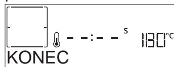
Stisknutím **►** budete pokračovat ve vaření s ručním režimem (bez časovače). Stisknutím **+** prodloužíte dobu vaření o nastavenou dobu. V obou případech budou nastavené parametry pro přípravu zachovány.
