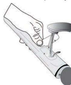
Pravilno vstavite predal za vodo v pečico in izberite funkcijo „Drain“ (izčrpavanje), pritisnite □ in počakajte, da se cikel samodejno začne. Povprečen čas trajanja izčrpavanja pri polni obremenitvi je približno ena minuta. Za tem lahko predal izvlečete in izpraznite.
