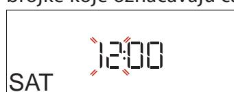
Pritisnite + ili — da podesite trenutni sat i pritisnite ✓ : Na ekranu će početi da trepere dve brojke koje označavaju minute.
