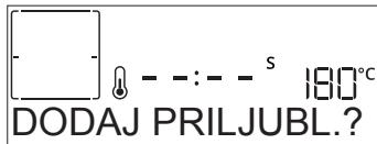
Če želite funkcijo dodati med priljubljene in shraniti trenutno nastavitev za prihodnjo uporabo, pritisnite ✓, v nasprotnem primeru zanemarite zahtevo in pritisnite ✕. Enkrat ko pritisnete ✓, pritisnite še + ali —, da izberete položaj številke, nato pritisnite ✓ za potrditev.
