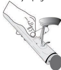
Tinkamai ištumë vandens stalčiuką į orkaitę, pasirinkite funkciją „Išleisti“, paspauskite ☐ ir palaukite, kol ciklas bus atliktas automatiškai. Vidutinė viso išleidimo trukmë yra apie viena minutę. Po to stalčių galima ištraukiti ir ištuštinti.
