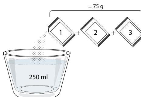
Kada sipate rastvor za uklanjanje kamenca u fioku, pritisnite da biste pokrenuli glavni proces za uklanjanje kamenca. Faze uklanjanja kamenca ne zahtevaju da ostanete uz uređaj. Po završetku svake faze, oglasiće se zvučni signal i na ekranu će se prikazati uputstva za prelazak na sledeću fazu. Po završetku faze uklanjanja kamenca potrebno je isprazniti vodu iz kotla: rastvor za uklanjanje kamenca koji se koristio tokom ove faze biće ispušten u izvlačnu fioku.
