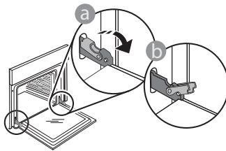
2. Dvířka dobře uzavřete. Pevně je držte oběma rukama – nedržte je za rukojet. Dvířka snadno vysadíte tak, že je budete nepřetržitě zavírat a současně za ně táhnout, dokud se neuvolní z usazení. Odložte dvířka na stranu na měkký povrch.
