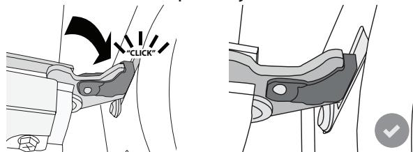
5. Pokušajte da zatvorite vrata i proverite da li su u istoj ravni sa kontrolnom tablom. Ukoliko nisu, ponovite gore opisane korake: Vrata se mogu oštetiti ukoliko nisu nameštena kako treba.
