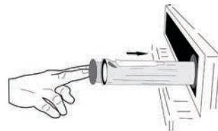
Efter den första påfyllningen kan det vara nödvändigt att fylla på igen för att kunna slutföra programmet, om det valda tillagningsprogrammet varar länge och vattnet tar slut: ugnen kommer att be dig att göra detta om det krävs.
