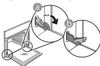
2. Vrata zaprite, kolikor je mogoče. Čvrsto primite vrata z obema rokama – ne držite jih za ročaj. Vrata boste lahko povsem preprosto demontirali, če jih še naprej zapirate in jih istočasno nekoliko vlečete navzgor, dokler se ne sprostijo iz vpetja. Odložite vrata na stran in na mehko površino.
