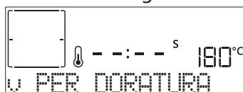
Quando il display mostra il messaggio corrispondente, premendo viene avviato un ciclo di doratura di cinque minuti. Questa funzione può essere interrotta in qualsiasi momento premendo per spegnere il forno.
