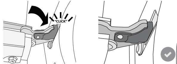
5. Prøv at lukke lågen, og tjek for at sikre, at den flugter betjeningspanelet. Gentag i modsat fald de ovenstående trin: Lågen kan tage skade, hvis den ikke virker som den skal.
