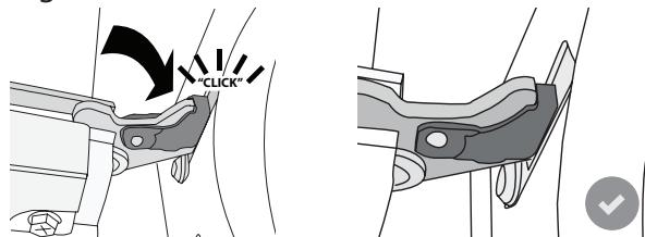
5. Proovige ust sulgeda ja vaadake, et see oleks juhtpaneeliga ühel joonel. Kui pole, korraage ülalkirjeldatud toiminguid: Kui uks ei liigu korralikult, võib see viga saada.
