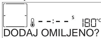
Ako funkciju želite spremiti kao omiljenu i spremiti trenutačne postavke za buduću upotrebu, pritisnite  , u protivnom za njihovo zanemarivanje pritisnite  . Nakon što pritisnete  , pritisnite + ili – za odabir položaja broja te zatim pritisnite  za potvrdu.
