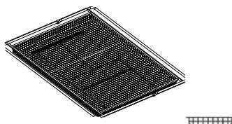
Poate fi utilizată atunci când gătiți alimente cu funcția Air Fry, cu o tavă de copt poziționată la un nivel inferior pentru a colecta eventualele firimituri și picături.
