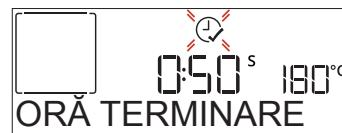
Apăsați + sau — pentru a seta ora la care doriti să se termine procesul de preparare, apoi apăsați ✓ pentru a confirma și activați funcția. Introduceți alimentele în cuptor și închideți ușa: Funcția va porni automat după calcularea perioadei de timp necesară pentru finalizarea preparării la ora setată.
