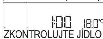
Zazní zvukový signál a displej bude indikovat ukončení akce. Zkontrolujte jídlo, uzavřete dvířka a pro pokračování v přípravě stiskněte **►** nebo **✓**. Upozornění: Pro přeskočení těchto kroků stiskněte **►**. Pokud nebude proveden žádný zásah, trouba bude po uplynutí určité doby pokračovat v pečení.
