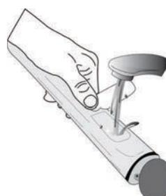
Odaberite funkciju „Drain“ (Ispuštanje) kad je latica za vodu ispravno umetnuta u pećnicu, pritisnite  i pričekajte da se ciklus automatski pokrene. Potrebno je prosječno oko jedne minute za ispuštanje cijelog punjenja. Kad se završi, latica se može izvaditi i isprazniti.
