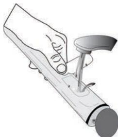
Izaberite funkciju „Ispuštanje vode“ dok je fioka za vodu pravilno umetnuta u pećnicu, pritisnite i sačekajte da se ciklus automatski pokrene. Prosečno trajanje potpunog ispuštanja vode iznosi oko jednog minuta. Po završetku, fioka se može izvući i
