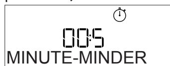
Zvučni signal će se oglasiti, a na displeju će se prikazati kada minutni podsetnik završi odbrojavanje izabranog vremena.
