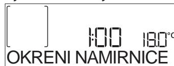
Oglasit će se zvučni signal i na zaslonu će se prikazati radnje koje treba obaviti. Otvorite vrata, napravite što se traži na zaslonu i zatvorite vrata te zatim pritisnite **►** za nastavak kuhanja.
