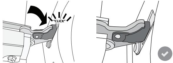
5. Zkuste dvířka zavřít a zkontrolujte, zda jsou v jedné rovině s ovládacím panelem. Pokud tomu tak není, výše uvedený postup opakujte: Pokud dvířka správně nefungují, mohou se poškodit.
