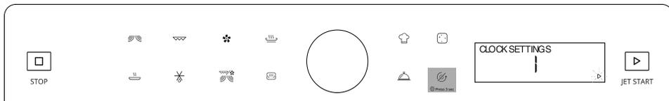
Puede establecer el reloj pulsando sin soltar el botón Stop TT (Detener TT) durante 3 segundos o la primera vez que se enchufa el aparato (o después de un corte de corriente); el producto entrará automáticamente en el modo de configuración del reloj.
