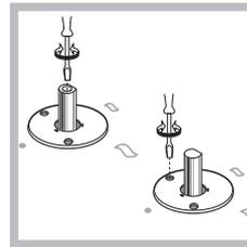
1. Retire o selector e ajuste o parafuso de regulação situado no interior ou ao lado da haste da torneira até obter uma pequena chama regular:
