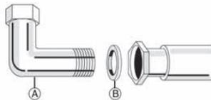
**IMPORTANTE:** se utilizar uma mangueira de aço inoxidável, esta deverá ser instalada de forma a não tocar em nenhuma parte móvel da mobília. Deverá passar através de uma área sem obstruções e onde seja possível a sua inspecção a todo o comprimento.
