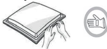
Coloque a placa na abertura da bancada feita respeitando as dimensões indicadas no manual de instruções.
