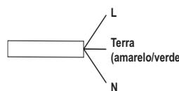
A ligação à terra do cabo distingue-se pelas cores amarelo - verde. No caso de instalação acima de um forno de encaixar, a ligação eléctrica do plano e a do forno precisam ser realizadas separadamente, seja por razões de segurança eléctrica, seja para facilitar uma eventual remoção do forno.
