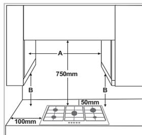
**NOTA:** Se a distância "A" entre a parede dos armários for entre 600 mm e 730 mm, a altura "B" terá de ser, no mínimo, de 530 mm. Se a distância "A"
