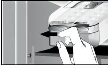
**ADVERTENCIA:** rellene usando agua potable solamente (nivel máximo = 2/3 de la capacidad total).
