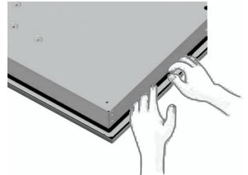
**Remarque :** le cordon d'alimentation électrique doit être suffisamment long pour permettre de soulever la table de cuisson du plan de travail.
