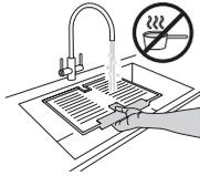
Folgen Sie den unten dargestellten Reinigungsvorgängen, um angesammeltes Eis auf dem STOP-FROST-Zubehörteil zu entfernen.
