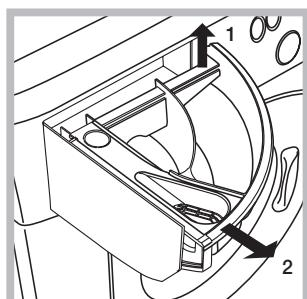
Extraiga el contenedor levantándolo y tirándolo hacia fuera (*ver la figura*). Lávolo debajo del agua corriente, esta limpieza se debe realizar frecuentemente.
