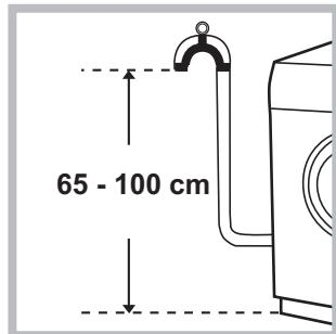
Під'єднайте зливний шланг, не згиноючи його, до каналізації або до зливного отвору у стіні на висоті від 65 до 100 см від підлоги.
