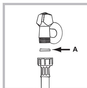
1. Wsunąć uszczelkę Ado końca rury pobierania wody i przykręcić ją do kurka zimnej wody o gwintowanym otworze 3/4" (zobacz rysunek). Przed podłączeniem spuszczać wodę do momentu, aż stanie się ona całkowicie przezroczysta.
