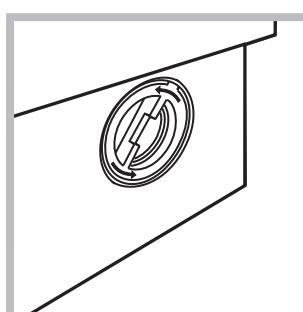
2. odskrutkujte veko otáčaním proti smeru hodinových ručičiek (viď obrázok): výtečenie malého množstva vody je úplne bežným javom;
