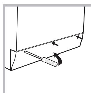
1. rimuovere il pannello di copertura sul lato anteriore della lavasciuga con l'ausilio di un giravite (*vedi figura*);
