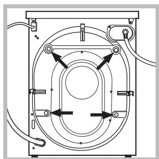
3. Scoateți cele șuruburi de protecție pentru transport și cauciucul cu distanțierul respectiv, situate în partea posterioară (a se vedea figura).
