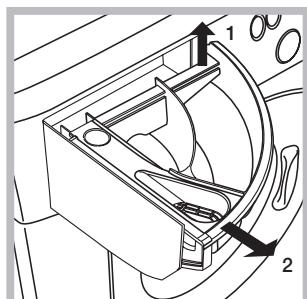
Vytiahnite dávkovač jeho nadvihnutím a vytiahnutím smerom von (viď obrázok). Dávkovač umyte pod prúdom vody; toto čistenie je potrebné vykonávať pravidelne.
