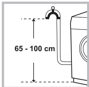
Podłączyć przewód odpływowy, nie zginając go, do rury ściekowej lub do otworu odpływowego w ścianie, które powinny się znajdować na wysokości od 65 do 100 cm od podłogi; albo oprzeć go na brzegu zlewu lub wannę, przymocowując do kranu prowadnik, znajdujący się w wyposażeniu pralki (patrz rysunek). Wolny koniec przewodu odpływowego nie powinien być zanurzony w wodzie.
