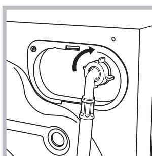
2. Conectați tubul de alimentare la mașina de spălat, înșurubândul la priza de apă respectivă, amplasată în partea posterioară, sus în dreapta (a se vedea figura).
