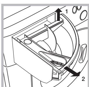
Vytáhněte dávkovač jeho nadzvednutím a vytažením směrem ven (viz obrázek). Umyjte jej pod proudem vody; tento druh vyčištění je třeba provádět pravidelně.
