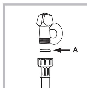
1. Вставте прокладку А у кінець труби для подачі води та вкрутіть його у кран з холодною водою за допомогою патрубка з різьбою 3/4 (див. малюнок). Перед підключенням спустіть воду, доки вона не стане прозорою.
