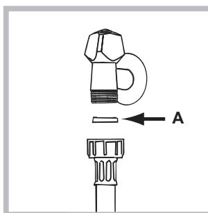
1. Introduceți garnitura A în extremitatea tubului de alimentare și înșurubați-l la un robinet de apă rece cu gura filetată de 3/4 gaz (a se vedea figura). Înainte de conectare, lăsați apa să curgă pentru a se limpezi.
