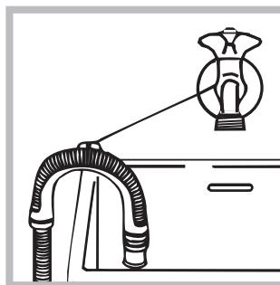
sau sprijinițil pe marginea unei chiuvete sau a unei căzi, legând elementul de ghidare la robinet (a se vedea figura). Capătul liber al furtunului de golire nu trebuie să rămână cufundat în
