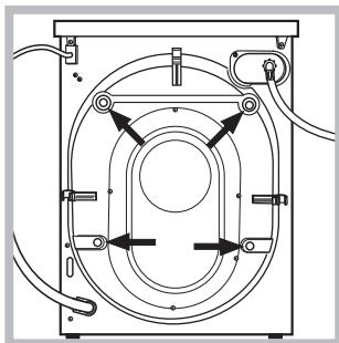
3. Odkręcić śruby zabezpieczające urządzenie na czas transportu oraz zdjąć gumowy element z podkładką, znajdujący się w tylnej części pralki (patrz rysunek).
