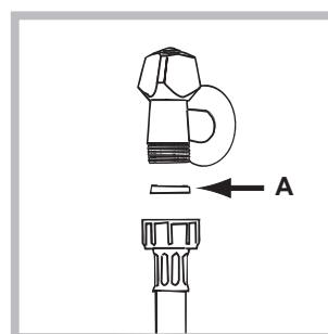
1. Vložte tesnenie A do koncovej časti prítokovej hadice a pripojte ju k uzáveru studenej vody so závitom 3/4" (viď obrázok). Pred pripojením hadice nechajte vodu odtieť, až kým nebude priezračná.
