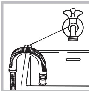
nebo ji uchyťte k okraji umývadla či vany a připevněte ji ke kohoutu prostřednictvím držáku z příslušenství (viz obrázek). Volný konec vypouštěcí hadice nesmí zůstat ponořený do vody.
