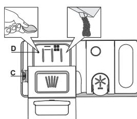
**Pour ouvrir le distributeur de détergent, utilisez le dispositif d'ouverture C. Insérez le détergent dans le distributeur sec D seulement. Placez la quantité de détergent pour le pré-lavage directement dans la cuve.**
