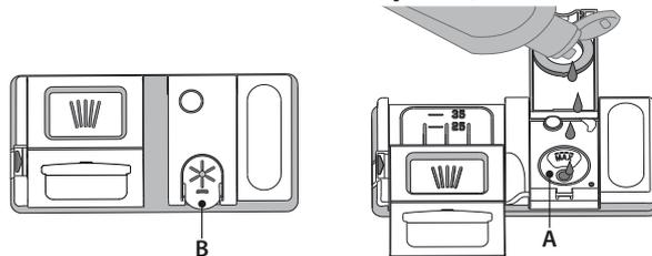
1. Ouvrez le distributeur B en appuyant et en tirant sur l'onglet sur le couvercle.
