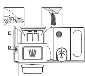
**Pour ouvrir le distributeur de détergent, utilisez le dispositif d'ouverture D. Insérez le détergent dans le distributeur sec E seulement. Placez la quantité de détergent pour le pré-lavage directement dans la cuve.**
