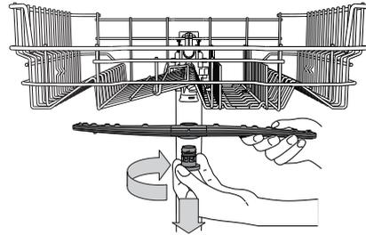
Pour enlever le gicleur supérieur, tournez l'anneau de verrouillage en plastique dans le sens horaire. Le bras d'aspersion supérieur doit être replacé de façon que le côté avec le plus grand nombre de trous est placé vers le haut.
