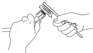
3. После этого вручную открутите заливной шланг от задней панели стиральной машины. С помощью плоскогубцев вытяните сетчатый фильтр из клапана на задней панели стиральной машины и тщательно очистите его.
