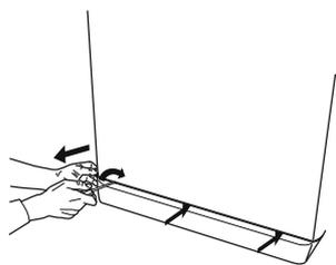
2. Емкость для слитой воды: установите низкую широкую емкость под водяной фильтр для сбора оставшейся воды.
