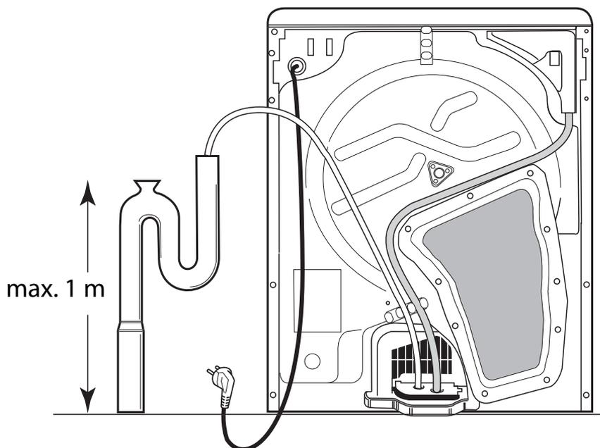
**REMARQUE :** pour éviter le refoulement, l'extrémité du flexible ne doit pas être plongée dans l'eau de vidange. Evitez de plier et de tordre le flexible.
