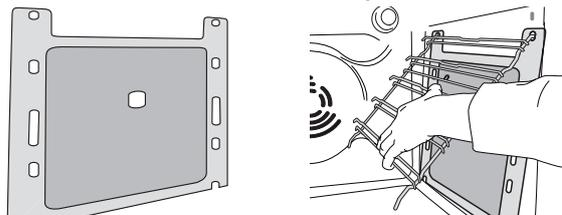
Pour profiter au maximum des propriétés auto-nettoyantes des panneaux catalytiques, nous vous conseillons de chauffer le four à 200 °C pour environ une heure en utilisant la fonction « Convection forcée ». Le four doit être vide durant cette opération. Laissez ensuite le four refroidir avant d'enlever les résidus d'aliments qui restent avec une éponge non abrasive.
