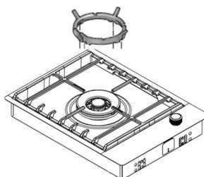
Se si devono usare sul bruciatore per wok pentole con diametro maggiore di 26 cm, utilizzare l'adattatore per wok in dotazione con l'orientamento opposto, come illustrato in figura (nottolini più lunghi verso il basso). Altrimenti si può danneggiare la superficie metallica del piano.
