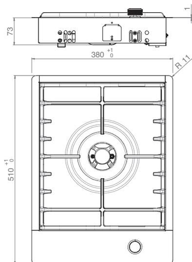
N.B.: per la versione con montaggio a semi-incasso, non è necessaria la fresatura di 1,5 mm.
