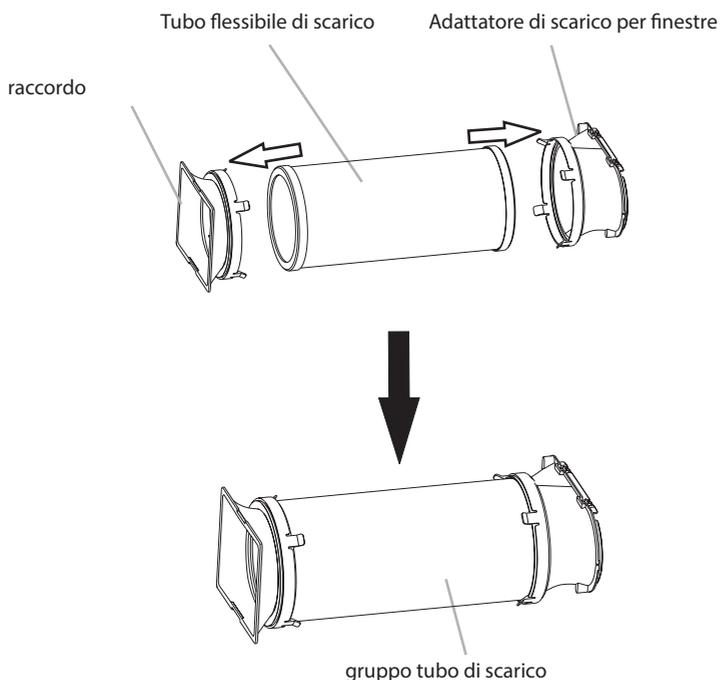
3. Inserire il falso raccordo nella fessura sul retro del climatizzatore.
