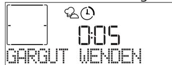
Ein akustisches Signal ertönt und das Display zeigt an, welche Tätigkeit auszuführen ist. Öffnen Sie die Tür, um die über das Display geforderte Tätigkeit auszuführen. Schließen Sie die Tür und setzen Sie den Garvorgang fort.
