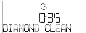
Drücken Sie zum Aktivieren der Funktion: Das Display fordert Sie auf, alle notwendigen Tätigkeiten auszuführen, um die besten Reinigungsergebnisse zu erzielen: Befolgen Sie die Anweisungen und drücken Sie , sobald diese erledigt sind. Nachdem Sie alle Schritte abgeschlossen haben, drücken Sie , wenn gefordert, um den Reinigungszyklus zu aktivieren.
