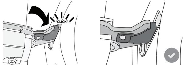
5. Versuchen, die Tür zu schließen und sicherstellen, dass sie auf das Bedienfeld ausgerichtet ist. Ist dies nicht der Fall, die oben aufgeführten Schritte wiederholen: Die Tür könnte beschädigt werden, wenn dies nicht richtig funktioniert.
