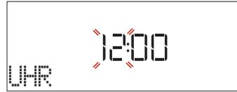
+ oder – drücken, um die aktuelle Uhrzeit einzustellen und  drücken: Auf dem Display blinken die beiden Minutziffern.
