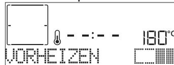
Sobald diese Phase beendet ist, ertönt ein akustisches Signal und das Display zeigt an, dass der Backofen die eingestellte Temperatur erreicht hat und die Aufforderung "GARGUT ZUFÜGEN". An dieser Stelle die Tür öffnen, die Speise in den Ofen stellen, die Tür schließen und den Garvorgang starten.
