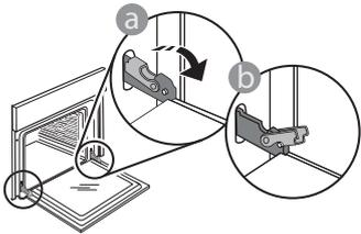
2. Die Tür so weit wie möglich schließen. Die Tür mit beiden Händen festhalten – diese nicht am Griff festhalten. Die Tür einfach entfernen, indem sie weiter geschlossen und gleichzeitig nach oben gezogen wird, bis sie sich aus ihrem Sitz löst. Die Tür seitlich abstellen und auf eine weiche Oberfläche legen.
