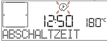
Drücken Sie + oder – zum Einstellen der Zeit für das Ende des Garvorgangs. Drücken Sie  zur Bestätigung und Aktivierung der Funktion. Die Speise in den Ofen stellen und die Tür schließen: Die Funktion startet automatisch nach der berechneten Zeit, damit der Garvorgang zur eingestellten Zeit endet.
