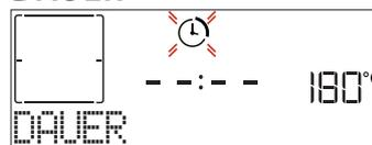
Wenn das Symbol auf dem Display blinkt, drücken Sie + oder – zum Einstellen der gewünschten Garzeit, und drücken Sie anschließend  zur Bestätigung.
