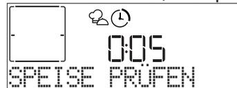
Ein akustisches Signal ertönt und das Display zeigt an, welche Tätigkeit auszuführen ist. Kontrollieren Sie die Speise, schließen Sie die Tür und nehmen Sie den Garvorgang wieder auf.
