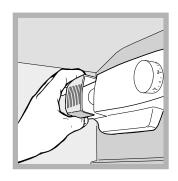
Accedere alla lampada togliendo la protezione come indicato in figura. Sostituirla con una analoga di potenza a quella indicata sulla protezione (15 W o 25 W).
