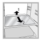
**RIPIANI**: pieni o a griglia. Sono estraibili e regolabili in altezza grazie alle apposite guide (*vedi figura*), per l'inserimento di contenitori o alimenti di notevole dimensione. Per regolare l'altezza non è necessario
