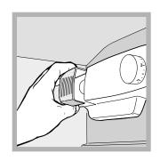
Para obter acesso à lâmpada, retire a protecção da maneira indicada na figura. Substitua-a por uma de potência análoga à indicada na protecção (15 W o 25 W).
