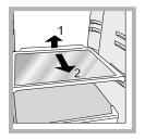
**BANDEJAS:** enteras o tipo rejilla. Son extraíbles y su altura es regulable gracias a las guías especiales (*ver la figura*), se utilizan para introducir recipientes o alimentos de gran tamaño. Para regular la altura no es necesario extraer las
