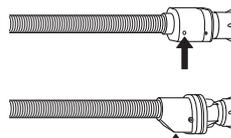
For slanger med vannstopp: sjekk det lille inspeksjonsvinduet til sikkerhetsventilen (se pil). Hvis det er rødt, var funksjonen for vannstopp tettet til, og slangen må byttes ut med en ny. For å skru løs slangen, trykk på knappen for frigjøring (dersom denne er tilgjengelig) mens du skrur løs slangen.
