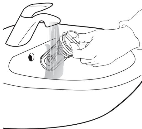
**6.** Inserte el filtro de agua y vuelva a instalar el zócalo: Vuelva a insertar el filtro de agua girándolo en el sentido de las agujas del reloj. Asegúrese de que lo ha girado todo lo posible el agarre del filtro debe estar en posición vertical. Para probar la estanqueidad del filtro de agua, puede verter alrededor de un litro de agua en el dispensador de detergente.
