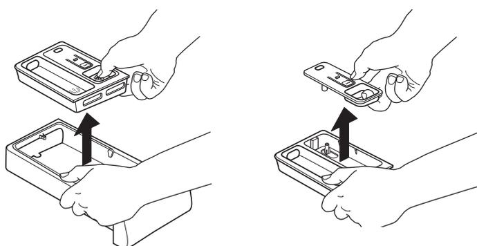
**5.** Vuelva a montar el dispensador de detergente y vuelva a introducirlo en el compartimento para el detergente.
