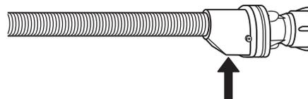
Para las mangueras de desagüe: compruebe la ventanilla de inspección de la válvula de seguridad (vea la flecha). Si es de color rojo, significa que la función desagüe estaba activada, y deberá sustituir la manguera por una nueva.
