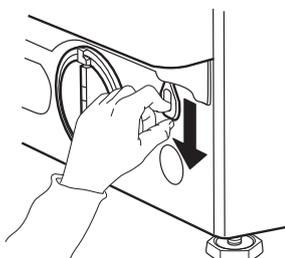
**4.** A continuación, vuelva a fijar la brida girándola firmemente en el tornillo con el destornillador.
