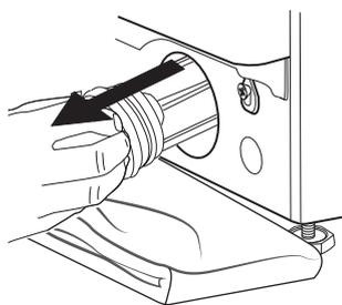
**5.** Limpiar el filtro de agua: retire los residuos del filtro y lávelo con agua corriente.
