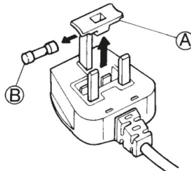
1. Extraiga la tapa del fusible (A) y el fusible (B).
