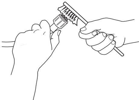
**3.** A continuación, desenrosque la manguera de entrada de la parte trasera de la lavadora. Extraiga el filtro de malla de la válvula de la parte trasera de la lavadora con unas pinzas y límpielo con cuidado.
