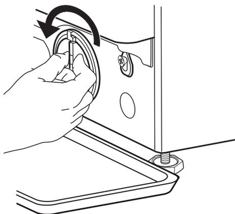
**4.** Retire el filtro: Ponga un trapo de algodón debajo del filtro de agua para absorber la pequeña cantidad de agua que quede. Retire el filtro de agua girándolo en el sentido de las agujas del reloj.
