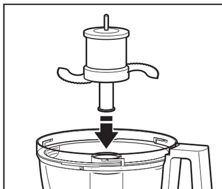
**2** Inserire l'adattatore motore nella mini-lama e posizionarlo nell'albero di trasmissione. Potrebbe essere necessario ruotare la lama finché non arriva nella posizione corretta. Premere per bloccare in posizione.
