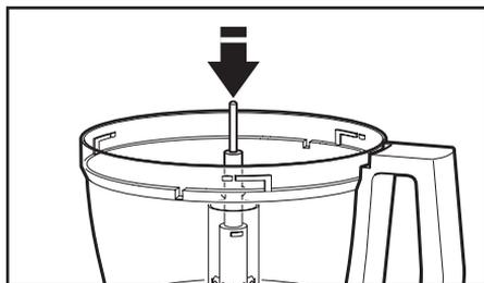
**1** Con la ciotola da lavoro montata, posizionare l'adattatore motore nell'albero di trasmissione sulla base.
