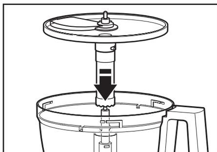
**3** Abbassare la lama e l'adattatore per affettare nell'adattatore motore.
