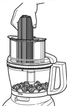
Tagliare gli alimenti in modo da riuscire a inserirli facilmente nel tubo alimenti in senso verticale o orizzontale e pressare il tubo alimenti per posizionare correttamente il contenuto. Lavorare esercitando una pressione uniforme.
