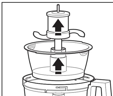
**4** Per rimuovere la mini-ciotola dopo la lavorazione, rimuovere la mini-lama tirando il tappo dritto verso l'alto. Sollevare la ciotola dritta verso l'alto e rimuoverla, utilizzando i due punti di presa per le dita posizionati sul bordo superiore della ciotola.
