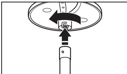
**2** Tenendo il disco per affettare regolabile nei due punti di presa per le dita, allineare i perni dell'adattatore del disco per affettare regolabile con le scanalature a L del disco. Far scivolare il disco nell'adattatore e ruotarlo per incastrare i perni nelle scanalature a L.
