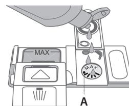
1. Ouvrez le distributeur A en appuyant et en tirant sur l'onglet sur le couvercle.
