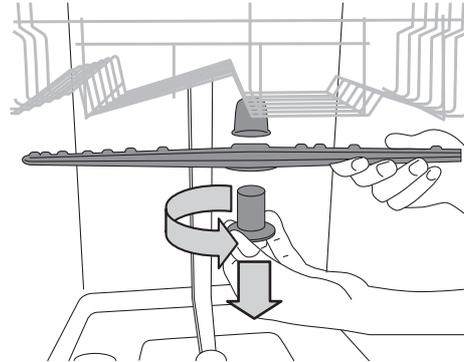
Pour enlever le bras d'aspersion supérieur, tournez l'anneau de verrouillage en plastique dans le sens antihoraire. Le bras d'aspersion supérieur doit être replacé de façon que le côté avec le plus grand nombre de trous est placé vers le haut.
