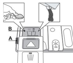
Pour ouvrir le distributeur de détergent, utilisez le dispositif d'ouverture A.
