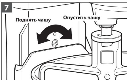
**7** **(ДОПОЛНИТЕЛЬНО) Для регулировки зазора между лопаткой и чашей:** опустите чашу в нижнее положение. Слегка поверните винт против часовой стрелки (влево), чтобы приподнять лопатку, или по часовой стрелке (вправо), чтобы опустить ее. Отрегулируйте лопатку таким образом, чтобы она просто очищала дно чаши. Еще раз проверьте зазор между лопаткой и чашей.
