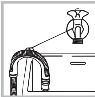
Կախեք ջրահեռացման խողովակի թեք ծայրը լվացարանի, լոգարանի կողքից կամ տեղադրեք կոյուղուհատուկ ելքում: Խողովակը չպետք է ծալվի: Ջրահեռացման խողովակի վերին կետը պետք է գտնվի գետնից 65-100 սմ. Բարձրության վրա: Ջրահեռացման խողովակի տեղակայումը պետք է ապահովի ջրահեռացման հասքի խզում (խողովակի ծայրը չպետք է գտնվի ջրի մեջ): Այլապես տեղադրեք ջրթափ ճկափողը լվացարանի կամ լոգարանի մեջ՝ ամրացնելով ուղղորդիչը (որը կարող է գնել տեխնիկական սպասարկման կենտրոնից) ձորակին (տես նկարը):
