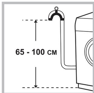
Подсоедините сливной шланг, не перегибая его, к сливной трубе или к настенному сливному отверстию, расположенному на высоте от 65 до 100 см от пола.
