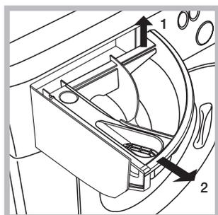
Выньте распределитель, приподняв его и потянув наружу (см. схему).
