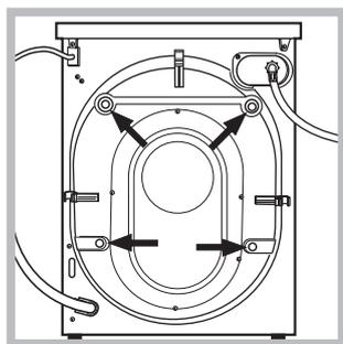
3. Машинаны ташуу жана керүү процессинде коргоочу, машинанын арткы бөлүгүндө жайгашкан 4 бураманы чыгарыңыз (схеманы кара.).
