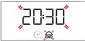
Utilice  $\pm$  o  $\bar{\square}$  para ajustar el tiempo deseado de finalización de la cocción y pulse  $\odot$  para confirmar.
