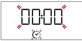
Utilisez  $\pm$  ou  $\bar{\pm}$  pour régler la durée de cuisson et appuyez sur  $\odot$  pour confirmer. Lancez la fonction en tournant le bouton du thermostat à la température désirée: un signal sonore et l'écran indiquent la fin de la cuisson.
