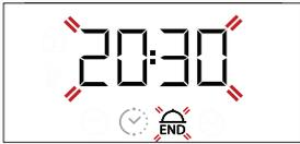
Utilize  $\pm$  ou  $\bar{\_}$  para definir o tempo de fim da cozedura pretendido e, em seguida, prima  $\odot$  para confirmar. Ative a função rodando o *botão do termóstato* para a temperatura requerida: a função irá permanecer em pausa até ser iniciada automaticamente após o período de tempo calculado para concluir a cozedura à hora programada.
