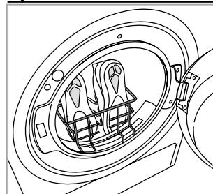
Uklonite filter vrata i postavite stalak. Vezice treba umetnuti unutar obuće: vrhove obuće treba okrenuti prema dolje a donove naprijed. **Nemojte dodavati drugo rublje ili obuću unutar bubnja.** Na kraju sušenja vratite filter vrata na mjesto.
