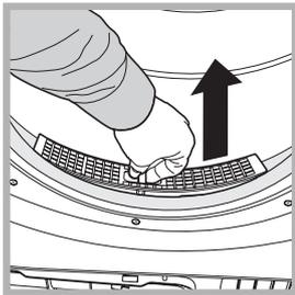
Al finalizar el secado limpie el filtro aclarándolo debajo de agua corriente o limpiándolo con una aspiradora. Si el filtro se atasca, el flujo de aire en el interior de la secadora se verá gravemente comprometido: los tiempos de secado se prolongan y se consume más energía. Además, pueden producirse averías en la secadora. El filtro se encuentra delante de la guarnición de la secadora (ver figura).
