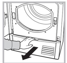
3. Limpie la superficie de las guarniciones y vuelva a posicionar la unidad con las flechas dirigidas hacia arriba, asegurándose que los topes estén bien fijados.
