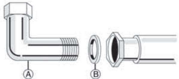
**Atención:** si se utiliza un tubo flexible de acero inoxidable, debe instalarse de modo que no toque las partes móviles del mueble. Debe pasar por zonas sin obstrucciones en las que sea posible inspeccionarla en toda su longitud.
