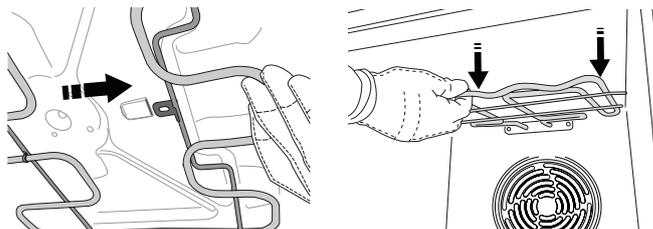
**2.** Чтобы вернуть нагревательный элемент в рабочее положение, поднимите и немного вытяните его на себя, а затем вставьте планку крепления в соответствующее гнездо.
