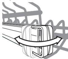
Ouvrir les butées installées à droite et à gauche et sortir le panier.
