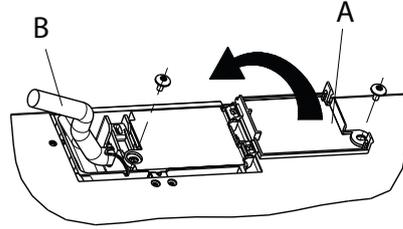
Urządzenie należy podłączyć do zasilania elektrycznego za pomocą wielobiegunowego wyłącznika o minimalnym odstępie pomiędzy stykami wynoszącym 3 mm.
