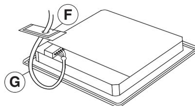
**O aparelho tem de ser ligado à alimentação elétrica através de um disjuntor multipolar com distância mínima entre os contactos de 3 mm.**
