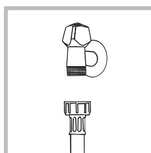
1. Reliez le tuyau d'alimentation en le vissant à un robinet d'eau froide à embout fileté 3/4 gaz (*voir figure*).
