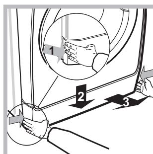
1. Nehmen Sie die Abdeckung an der Gerätetür ab, indem Sie zur Mitte hin drücken, dann drücken Sie beide Seiten nach unten und ziehen sie heraus (siehe Abbildungen).
