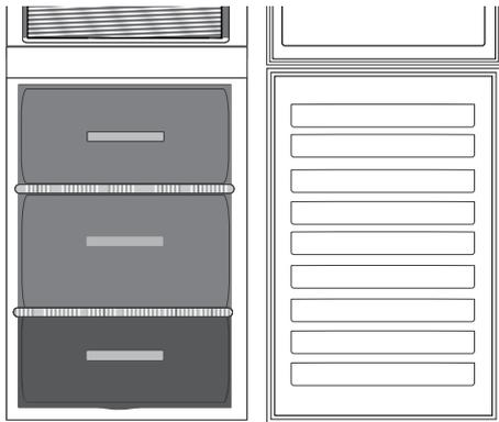
Zur Erhöhung der Lagerkapazität kann das Gefrierfach auch ohne die Schubfächer des Gefrierbereichs verwendet werden. Sicherstellen, dass die Türe richtig geschlossen ist.
