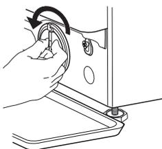
9. Rimuovere il filtro: Disporre un telo di cotone sotto il filtro dell'acqua, in modo che possa assorbire una piccola quantità di acqua residua. Rimuovere quindi il filtro dell'acqua ruotandolo in senso antiorario.
