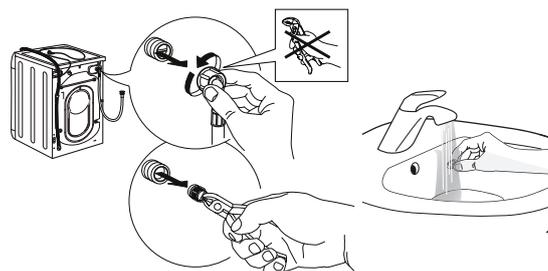
4. Reinscrivere il filtro a rete. Ricollegare il tubo di carico al rubinetto dell'acqua e alla lavatrice. Non usare utensili per collegare il tubo di carico. Aprire il rubinetto dell'acqua e controllare che tutti i collegamenti siano ben stretti.
