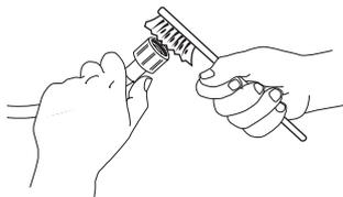
3. A questo punto, svitare manualmente il tubo di carico sul lato posteriore della lavatrice. Usando una pinza, estrarre il filtro a rete dalla valvola sul retro della lavatrice e pulirlo.
