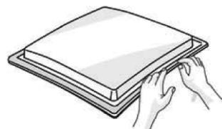
Coloque la placa en la abertura realizada en la encimera respetando las dimensiones indicadas en las instrucciones.
