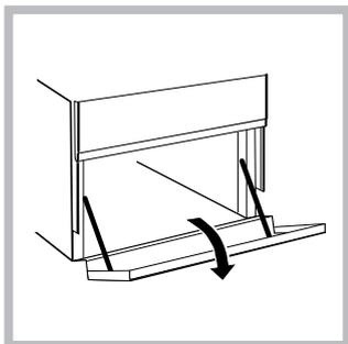
Une niche ménagée au-dessous du four peut être utilisée pour entreposer des accessoires ou des casseroles. Pour ouvrir le volet, faites-le pivoter vers le bas (voir figure).
