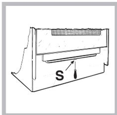
Pour enlever la protection coulissante "A", dévissez la vis S (voir figure). Pour la remonter, fixez-la à l'aide de la vis S.
