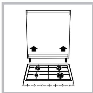
Pour le nettoyage des modèles équipés de couvercle en verre, utilisez de l'eau tiède. Évitez tout produit abrasif. Vous pouvez déposer le couvercle pour simplifier le nettoyage de la zone arrière du plan de cuisson : ouvrez-le complètement et tirez vers le haut (voir figure).
