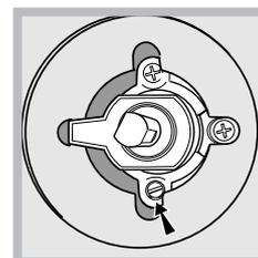
5. vérifier si, en tournant rapidement le bouton de la position MAX à la position MIN, ou en ouvrant et fermant rapidement la porte du four, le brûleur ne s'éteint pas.
