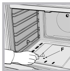
Pour allumer le brûleur du four, approchez une flamme ou un allume-gaz de l'orifice F (voir figure), poussez sur le bouton FOUR et tournez-le en même temps dans le sens inverse des aiguilles d'une montre jusqu'à la position MAX.
