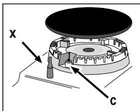
Si l'appareil est équipé d'un allumage électronique\* (C) il suffit de pousser et de tourner en même temps dans le sens inverse des aiguilles d'une montre le bouton BRULEUR sur le symbole petite flamme, jusqu'à l'allumage. Il peut
