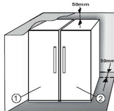
Er wordt aanbevolen twee apparaten samen te installeren met behulp van de verbindingsset ③ (zie de afbeelding). Deze kunt u aanschaffen bij de Consumentenservice.
