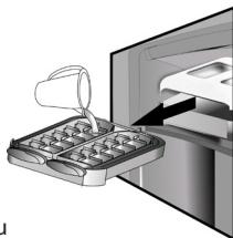
Replacez la fabrique à glaçons dans le compartiment congélateur, ou réinsérez le plateau à glaçons dans la fabrique à glaçons. Veillez à ne pas renverser d'eau.
