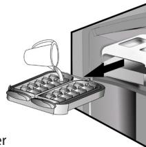
Setzen Sie den Ice Mate in das Gefrierfach zurück oder führen Sie die Eiswürfelschublade wieder in den Ice Mate ein. Verschütten Sie hierbei kein Wasser.
