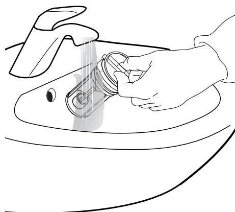
**6.** Sett vannfilteret tilbake på plass og monter sokkelen: Sett vannfilteret inn igjen ved å vri det med urviseren. Påse at du har vridd det så langt inn som mulig; Filterets håndtak skal befinner seg i vertikal posisjon. For å teste at vannfilteret er strammet til, kan du helle omtrent 1 liter vann ned i vaskemiddelbeholderen.
