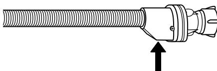
For slanger med vannstopp: sjekk det lille inspeksjonsvinduet til sikkerhetsventilen (se pil). Hvis det er rødt, var funksjonen for vannstopp tettet til, og slangen må byttes ut med en ny. For å skru løs slangen, trykk på knappen for frigjøring (dersom denne er tilgjengelig) mens du skrur løs slangen.
