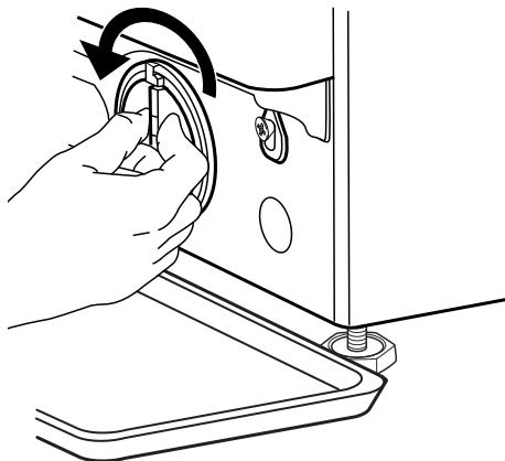
**5.** Gjør vannfilteret rent: fjern rester i filteret og gjør det rent under rennende vann.
