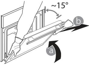
3. Asenna luukku takaisin siirtämällä se uunin lähelle, kohdistuen saranoiden koukut sijoituskohtiin ja kiinnittämällä yläosan paikalleen.
