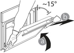
3. Ukse tagasipaigaldamiseks asetage see vastu ahju, joondage hingede haagid pesadega ja kinnitage ülemine osa oma pesa.
