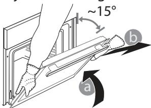
3. Sätt tillbaka luckan genom att flytta den mot ugnen och placera gångjärnens krokar i höjd med fästet och fästa den övre delen på fästet.
