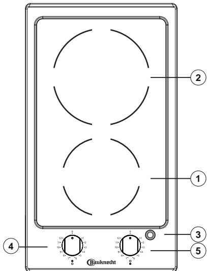
1. Zona di cottura radiante Ø 145 mm
