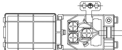
**L'appareil doit être raccordé au secteur à l'aide d'un dispositif à coupure omnipolaire ayant une distance de 3 mm au moins entre les contacts.**
