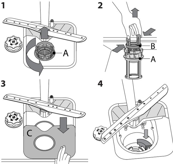
Depois de limpar os filtros, volte a colocar o conjunto de filtros e fixe-o corretamente na devida posição; isto é essencial para manter um funcionamento eficaz da máquina de lavar loiça.
