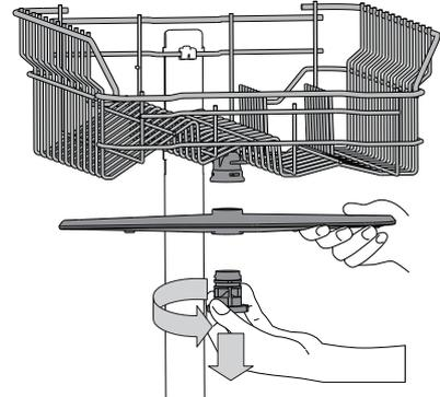
Para retirar o braço aspersor superior, rode o anel de bloqueio de plástico no sentido contrário ao dos ponteiros do relógio. O braço aspersor superior deve ser recolocado de modo a que o lado com mais orifícios fique voltado para cima.
