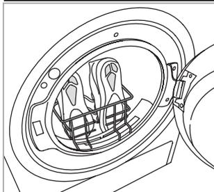
Rimuovere il filtro porta e posizionare la rastrelliera. I lacci devono essere infilati all'interno delle scarpe: punte rivolte verso il basso e le soles davanti. **Non aggiungere biancheria o altre scarpe dentro il cesto.** Riposizionare il filtro porta al termine dell'asciugatura.
