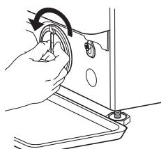
4. Uklonite filter: ispod filtera stavite pamučnu krpu koja može da upije manju količinu preostale vode. Potom uklonite filter za vodu tako što ćete ga okretati u smeru suprotnom od kretanja kazaljke na satu.
