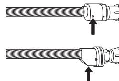
Kod creva sa funkcijom prekida vode: proverite mali prozor za inspekciju sigurnosnog ventila (vidite strelicu). Ako je crven, aktivirana je funkcija prekida vode, a crevo se mora zameniti novim.
