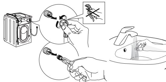
4. Vratite mrežasti filter u ventil. Ponovo priključite crevo za dovod vode na slavinu za vodu i mašinu za pranje veša. Uradite to bez alata. Otvorite slavinu za vodu i proverite da li ste čvrsto priključili crevo.
