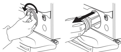
5. Očistite filter za vodu: uklonite preostale naslage sa filtera i očistite ga pod mlazom vode.
