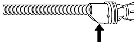
Pour les tuyaux d'arrêt d'eau : vérifiez la fenêtre d'inspection de la petite soupape de sécurité (voir la flèche). Si elle est rouge, la fonction d'arrêt d'eau a été déclenchée et le tuyau doit être remplacé par un nouveau.
