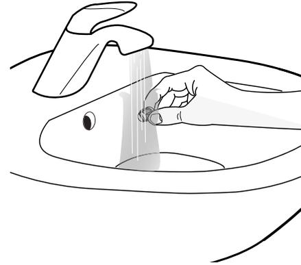
**4.** Replacez le filtre à tamis. Rebranchez le tuyau d'alimentation au robinet d'eau et au lave-linge. N'utilisez pas d'outils pour brancher le tuyau d'alimentation. Ouvrez le robinet d'eau et assurez-vous que tous les raccords sont bien serrés.
