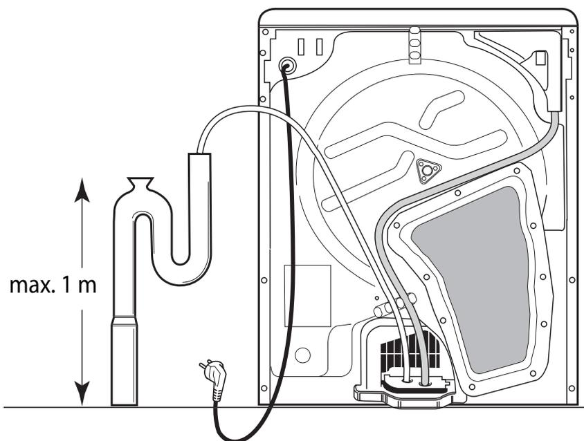
**REMARQUE :** pour éviter le refoulement, l'extrémité du flexible ne doit pas être plongée dans l'eau de vidange. Évitez de plier et de tordre le flexible.
